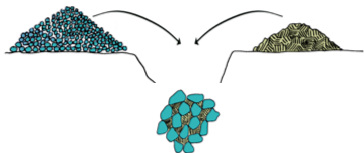
Détails de la réalisation du mélange terre-pierres avec les matériaux livrés séparément.
