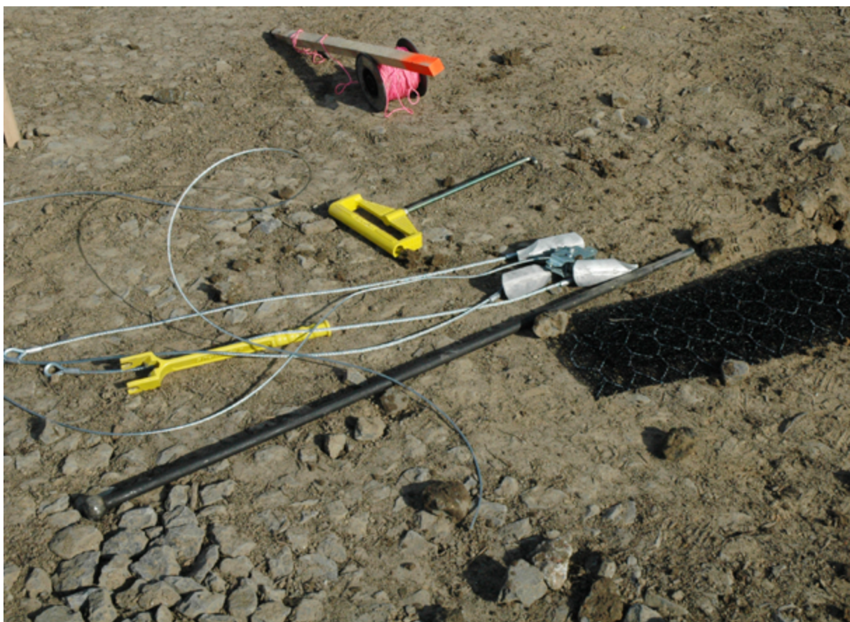
Matériel pour le maintien des arbres avec des ancrages de motte.
