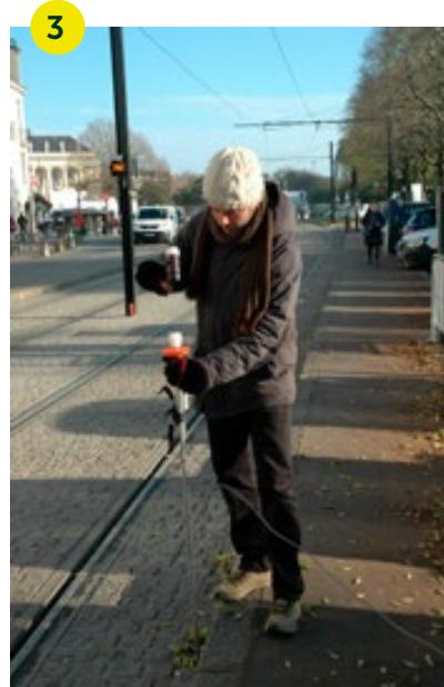
Mise en œuvre de la tomographie racinaire par les bureaux d'études Aubépine et Arbor étude sur la place Gloriette Petite Hollande, à Nantes, en novembre 2022. (1) Capteurs fixés à la base de l'arbre (en haut) ; (3) les capteurs sont reliés à la tige métallique (l'émetteur) qui est pointée sur le sol et frappée et à un ordinateur (2) qui enregistre les positions successives de la tige et les vitesses de l'onde sonore (en haut à droite et ci-dessus).
